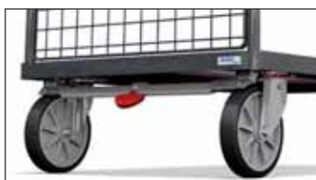
TOTALSTOP – het fetra centrale remsysteem Met slechts één voetbeweging wordt de wieldraaiing en de zwenkbeweging van beide zwenkwielen geblokkeerd. Het rempedaal blijft altijd in het zicht van de gebruiker. Seriematig op alle kastwagens.
